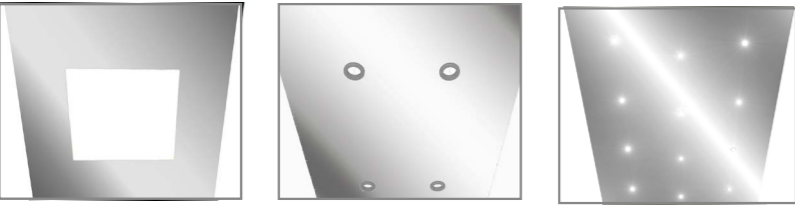
Éclairage avec panneau led Éclairage par projecteurs Ciel étoilé (points LED)
