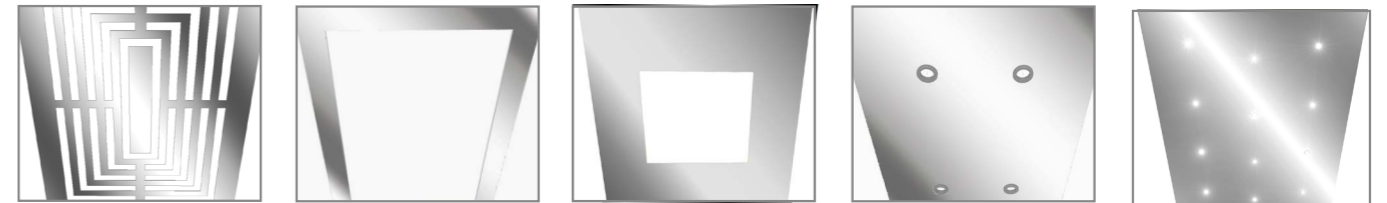
Multiforo labirinto Illuminazione con plexiglass Illuminazione con pannello led Illuminazione a faretti Cielo stellato (punti led)
